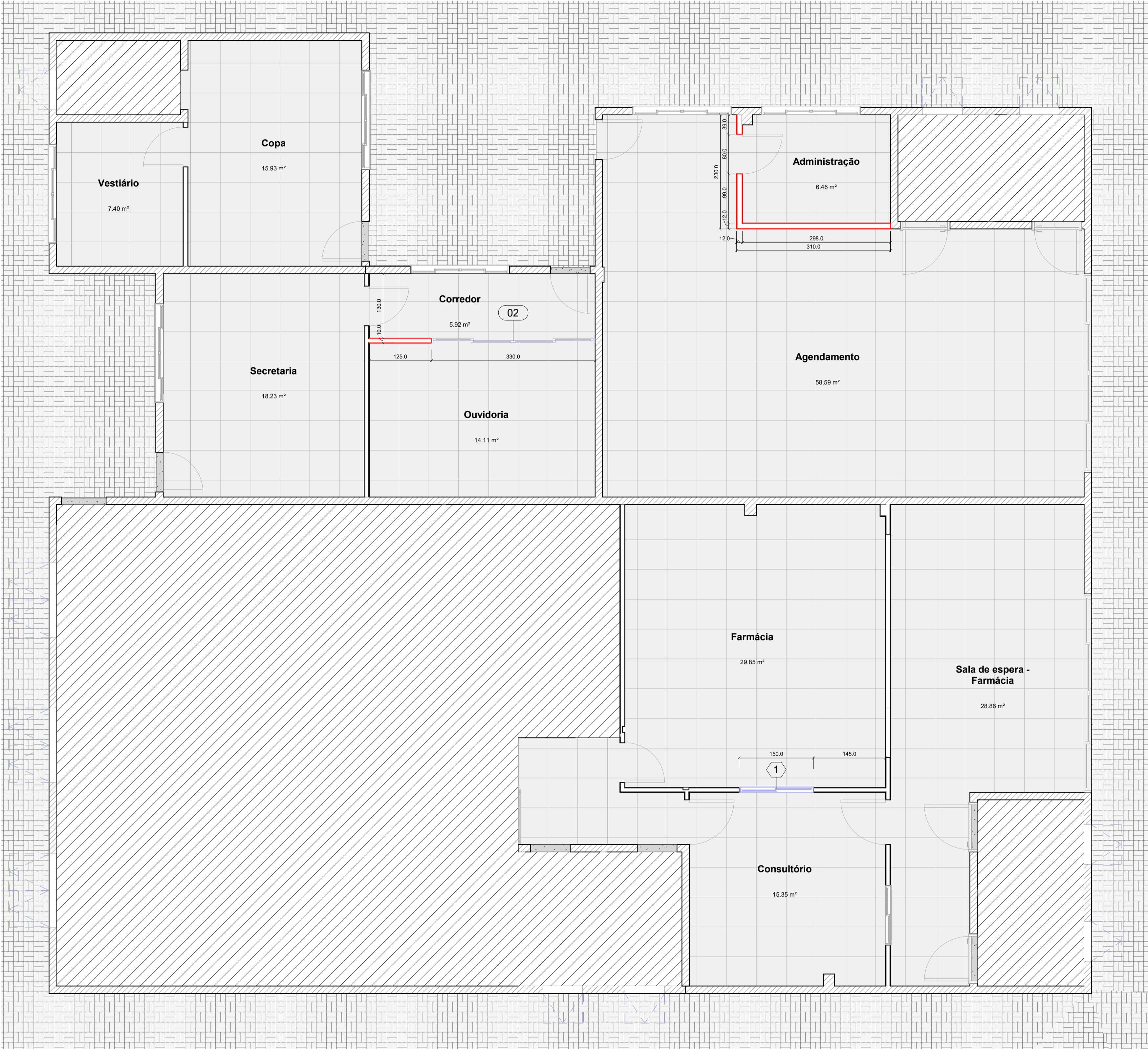
1 Planta de drywall e localização dos caixilhos 1 : 50
