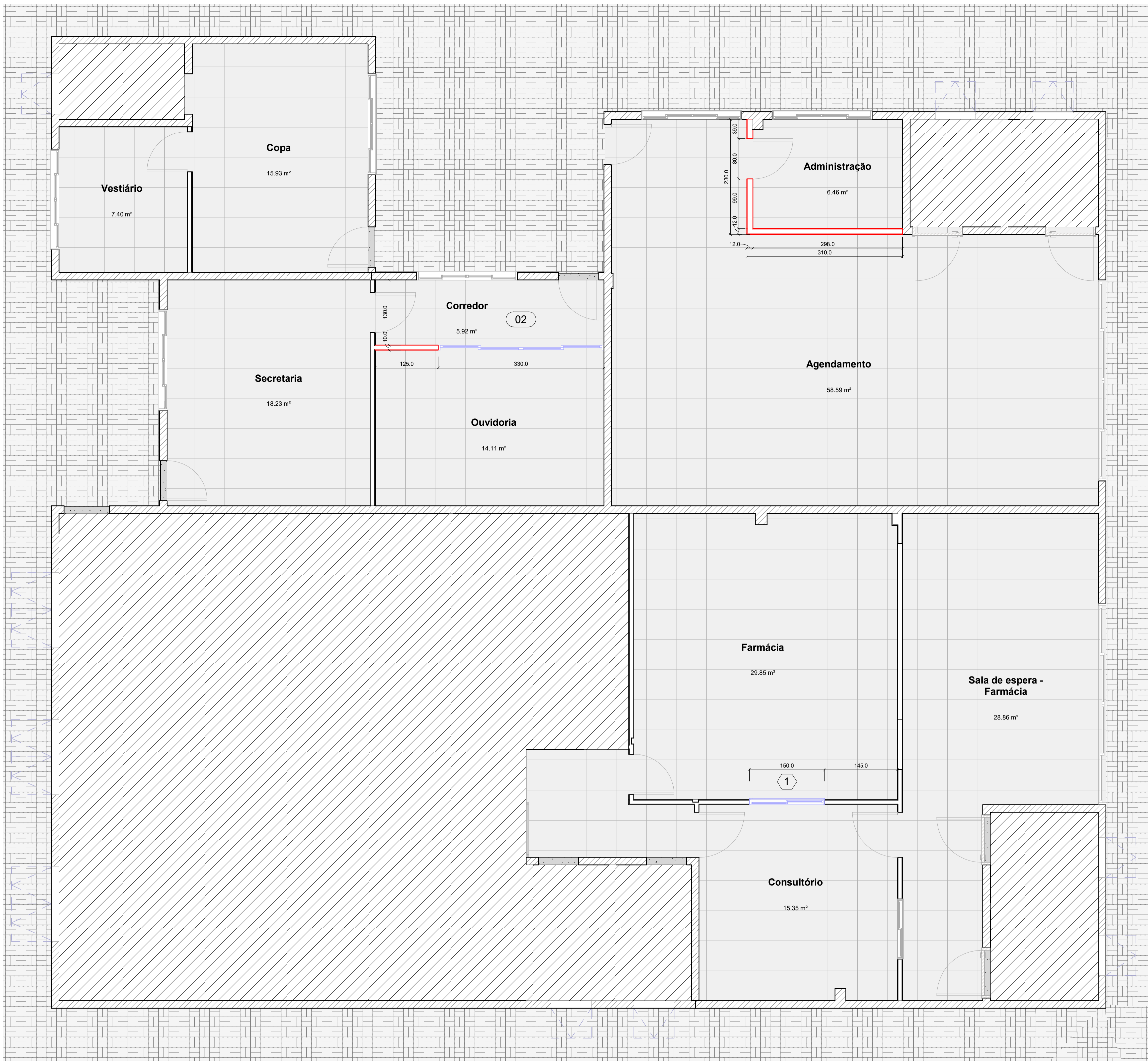
1 Planta de drywall e localização dos caixilhos 1 : 50
